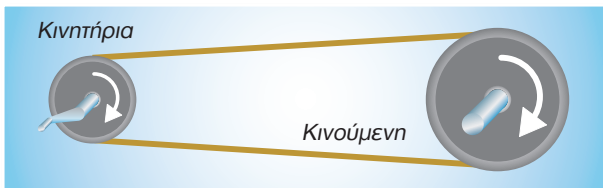
Μετάδοση κίνησης με μείωση της ταχύτητας
