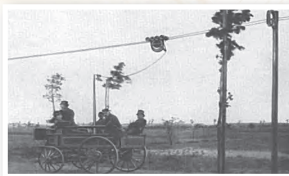
Ηλεκτροκίνητο όχημα που τροφοδοτείται με εναέρια γραμμή, 1882 ( www.sfrang.com/historia.htm )
