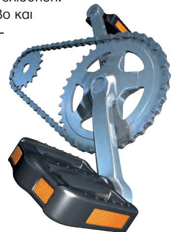
Η αλυσοκίνηση είναι ο βασικός μηχανισμός του ποδηλάτου
