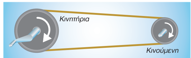
Μετάδοση κίνησης με αύξηση της ταχύτητας
